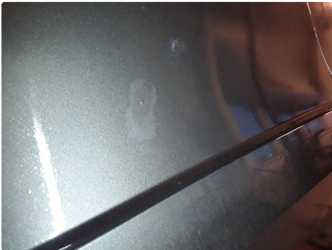
1.2 Liten steinsprut med korrosjon venstre fordør.
