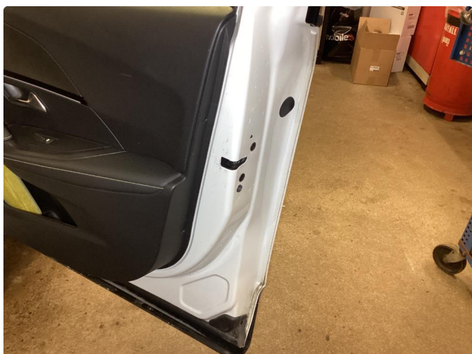
1.1 Rust i fals
