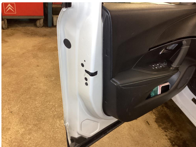
1.1 Rust i fals
