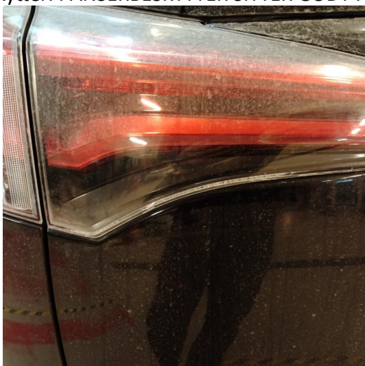
2.1 Sprekt venstre bak lampe indre. NOE SPREKKDANNELSER RUNDT LYKT, OG NOE MATT GLASS.
