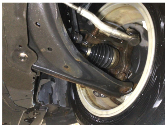
2.1 Overflaterust i forstilling, ingen tiltak kreves
