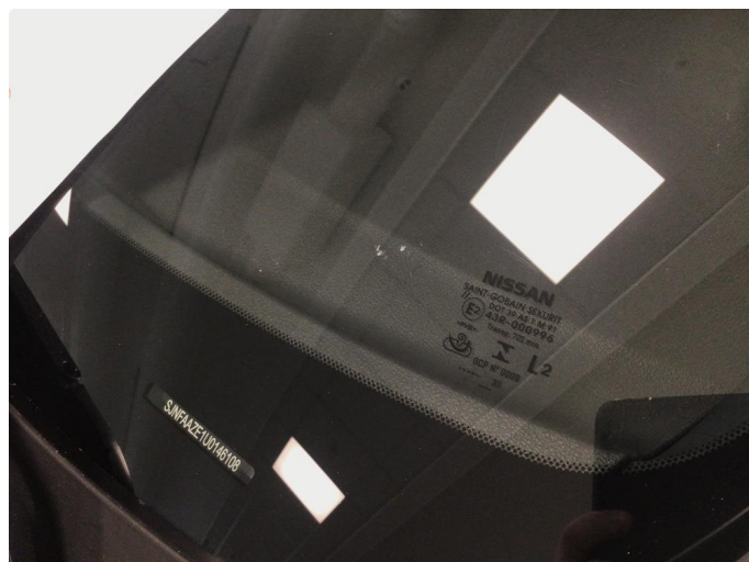
1.2 Noe steinsprut på frontvindu
