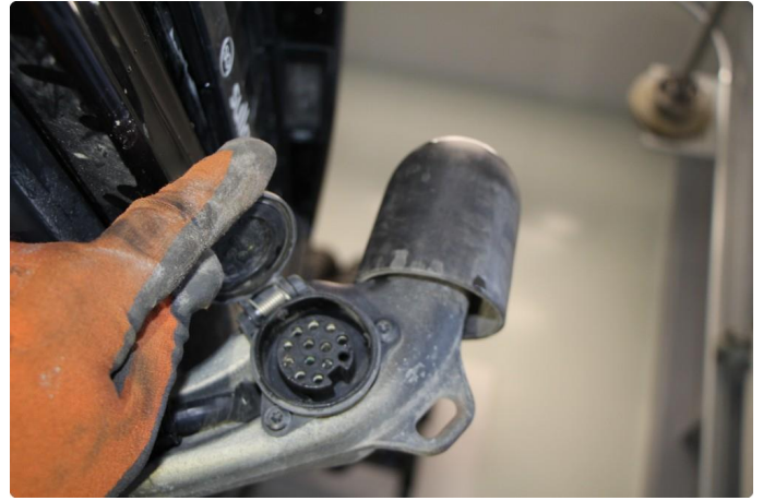
3.9 Tilhengerkontakt- innfesting skadet
