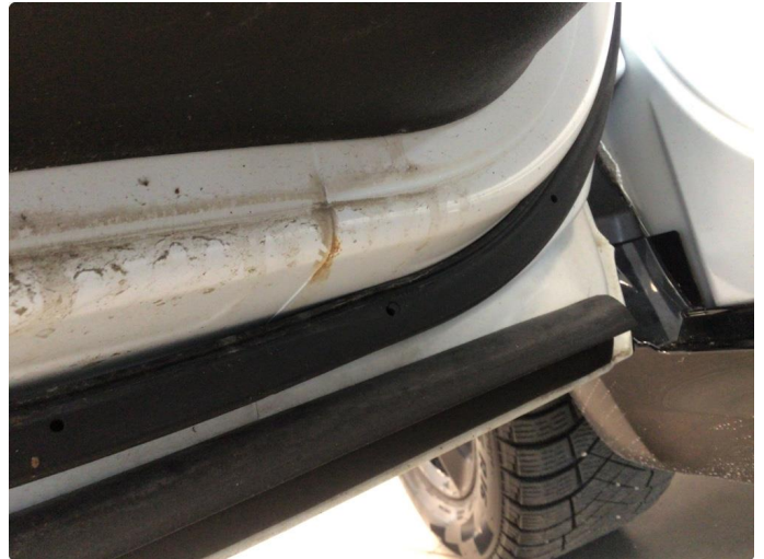
1.1 Noe overfladisk korrosjon på innsiden av bakluke og venstre framdør, dette i begrenset omfang og av liten betydning
