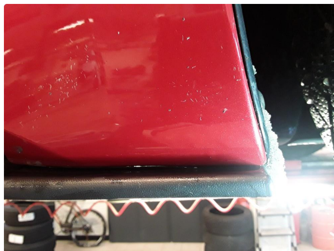
1.2 Liten steinsprut med korrosjon høyre forskjerm.
