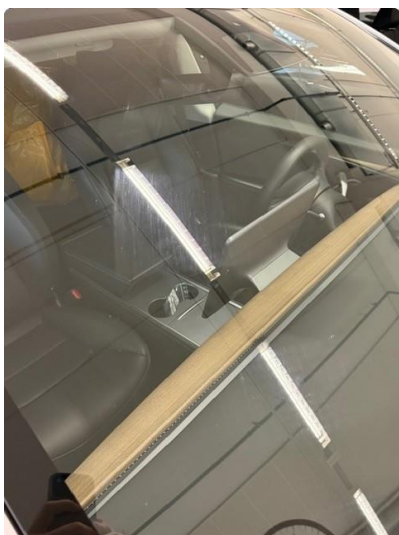
1.4 Litt slitemerker etter vinduspusser
