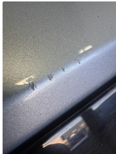
1.3 Noen riper og en liten steinsprut med korrosjon.
