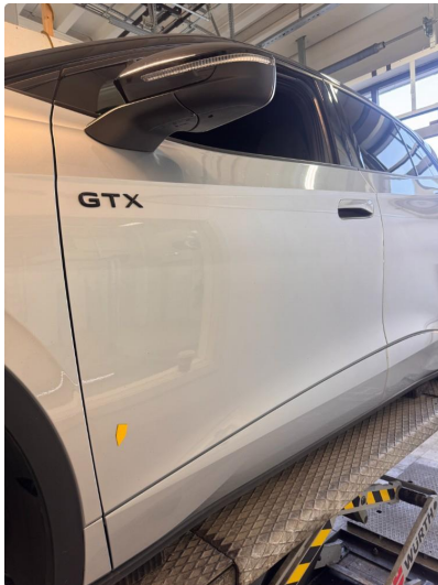
1.2 Liten steinsprut med korrosjon.
