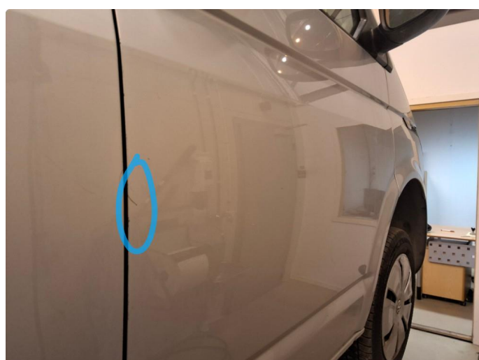
1.2 Ripe ned til grunning
