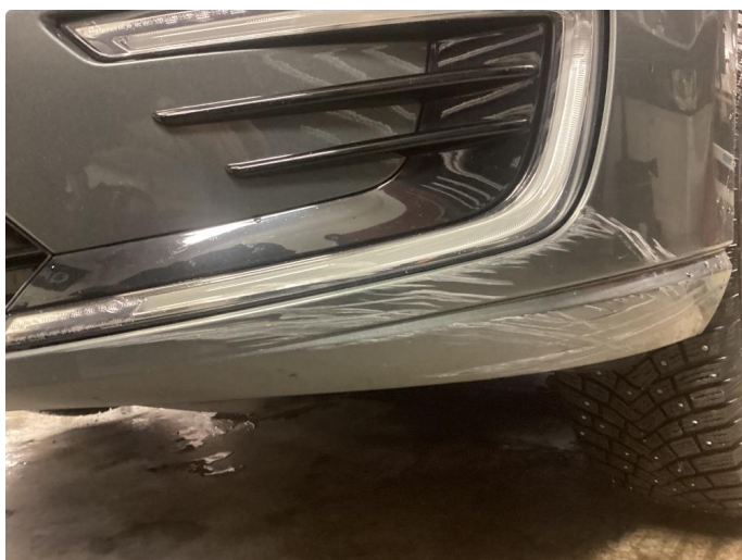
1.3 Lakk skade under støtfanger foran
