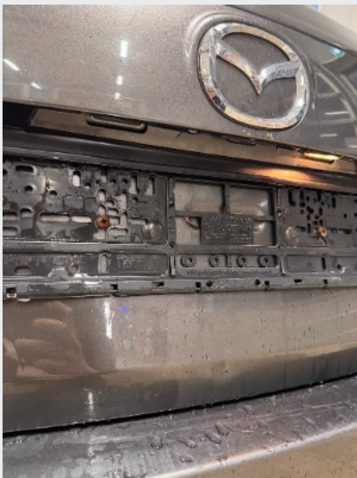
3.8 Defekt skiltlyspære v.s
