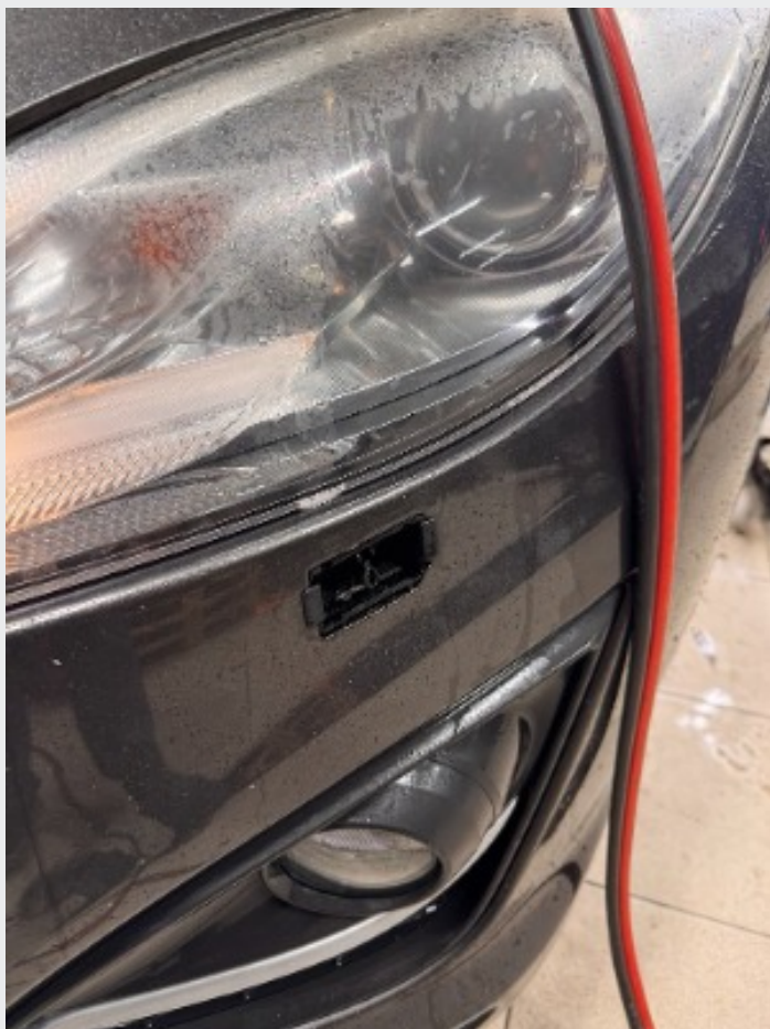
2.8 Mangler deksel til spyler dyse fram fanger.
