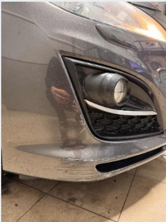
2.8 Skader på frontfanger.
