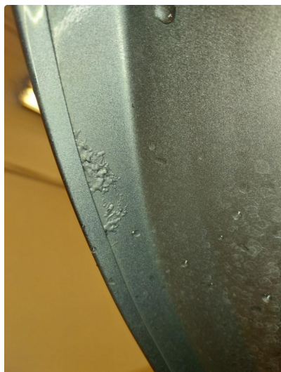
1.1 Rust i fals
