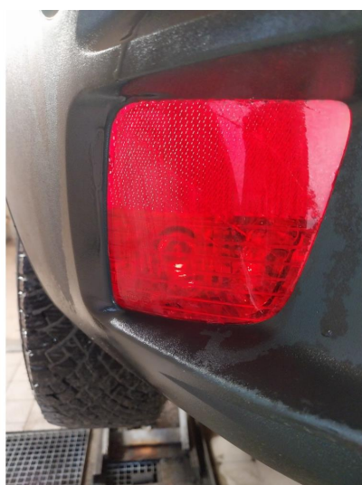
2.1 Defekt / sprukket glass
