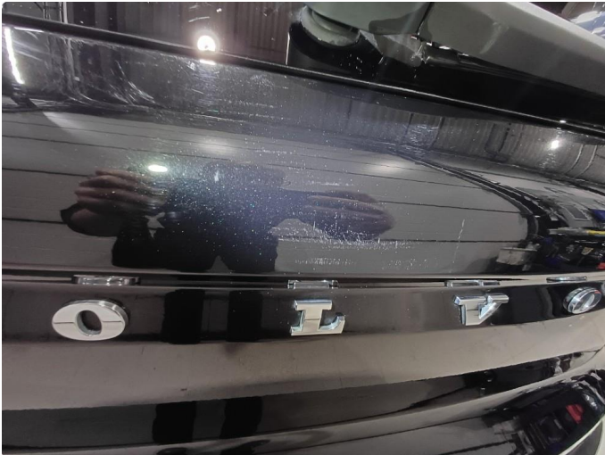
1.1 Noen riper og småbulker
