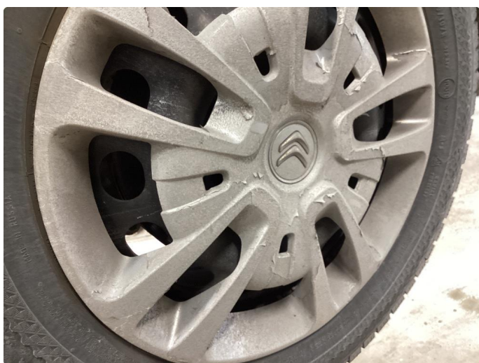
1.2 Hjul kapsel skadet
