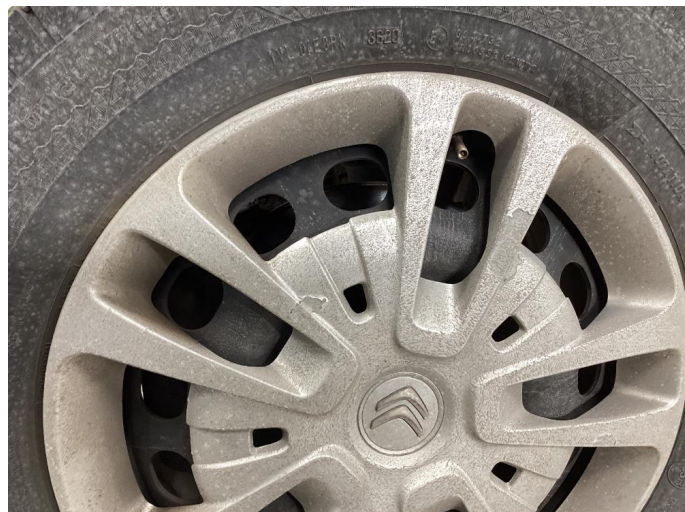
1.2 Hjul kapsel skadet
