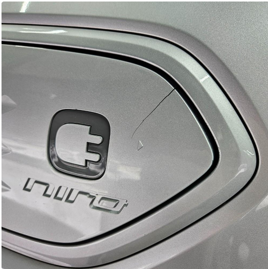
1.2 Liten sprekk i plastdeksel/lokk, funksjon er OK
