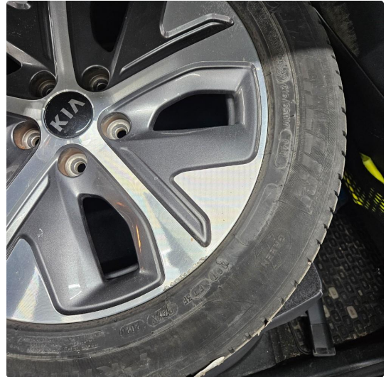
1.1 Noen skrubbermerker på sommer/vinter-felg
