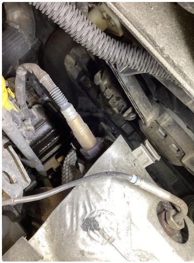
2.2 Oljelekkasje fra motor. Sølt ved fylling
