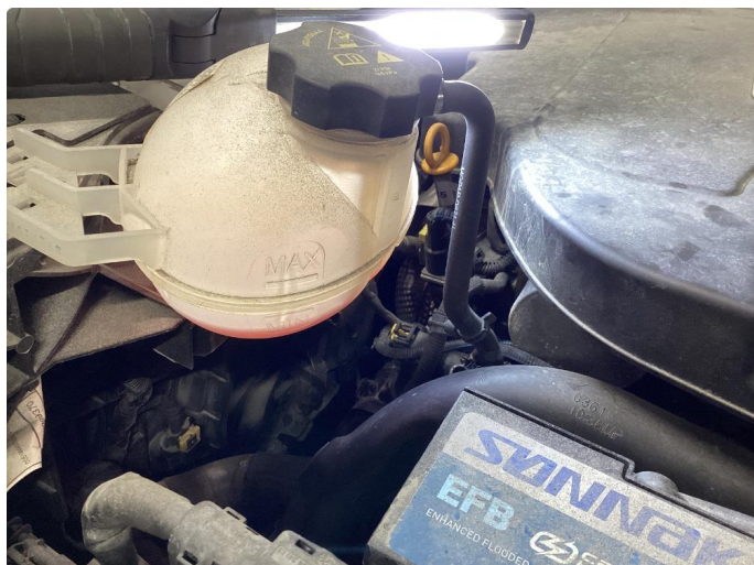
2.1 Kjøleveske under minimum . Etterfylt
