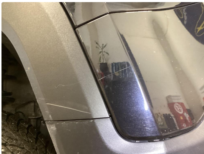
1.10 Ripe(r) ned til grunning
