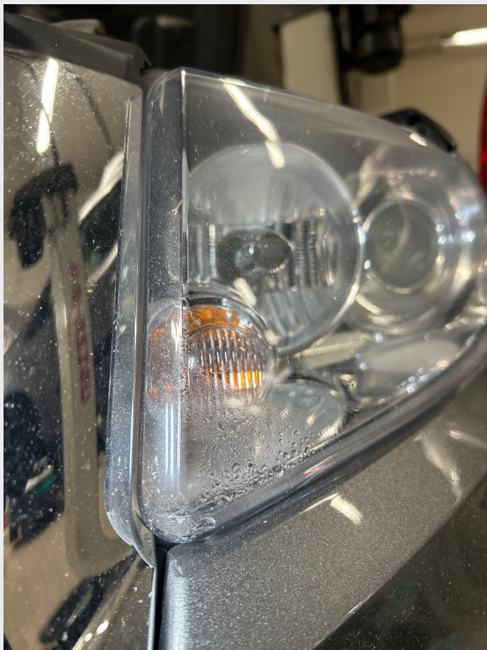
3.1 Litt fukt i lykt v.f.
