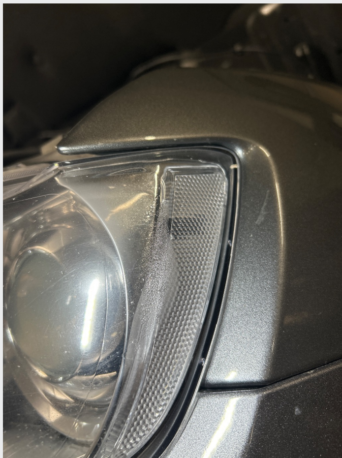
3.1 Litt fukt i lykt v.f.
