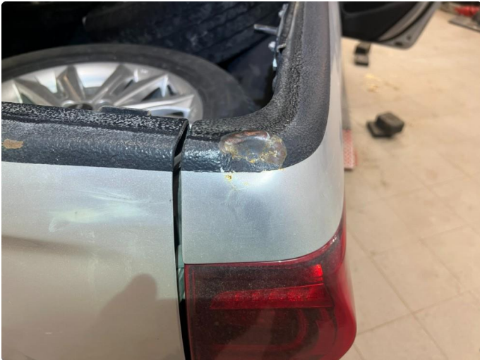
1.1 Forurensing lakk ytre påvirkning
