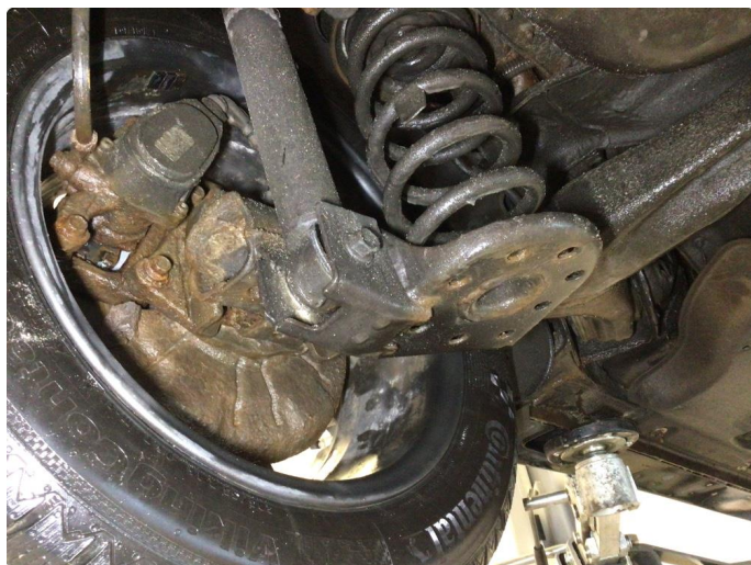
3.1 Overflaterust i bakstilling, ingen tiltak kreves
