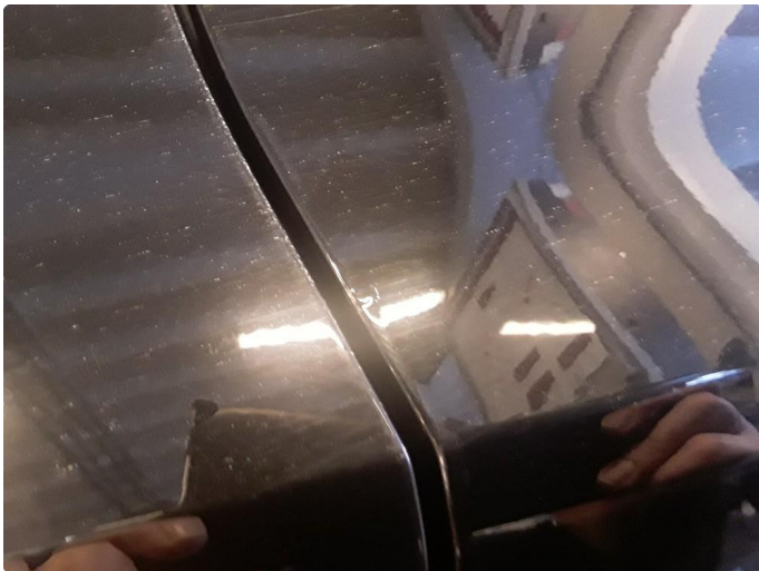
1.3 Liten steinsprut med korrosjon høyre fordør.
