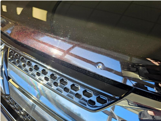
1.1 Hakk/skade i lakken
