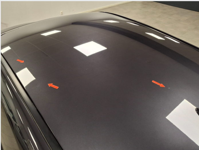
2.10 2stk små bulker på tak + noe steinsprut/merker
