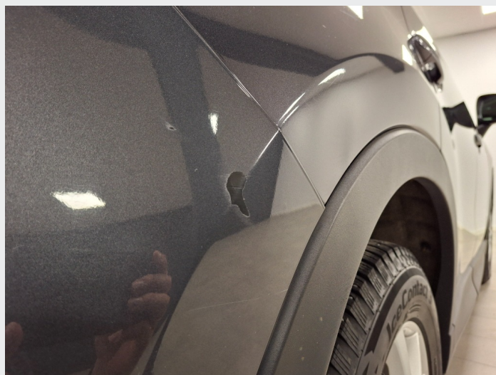
2.7 Liten bulk på skjerm + ripe på fanger h.s.b
