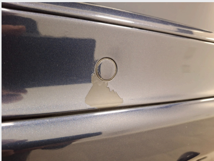
2.8 Lakk som har flasket av rundt sensor på fanger bak
