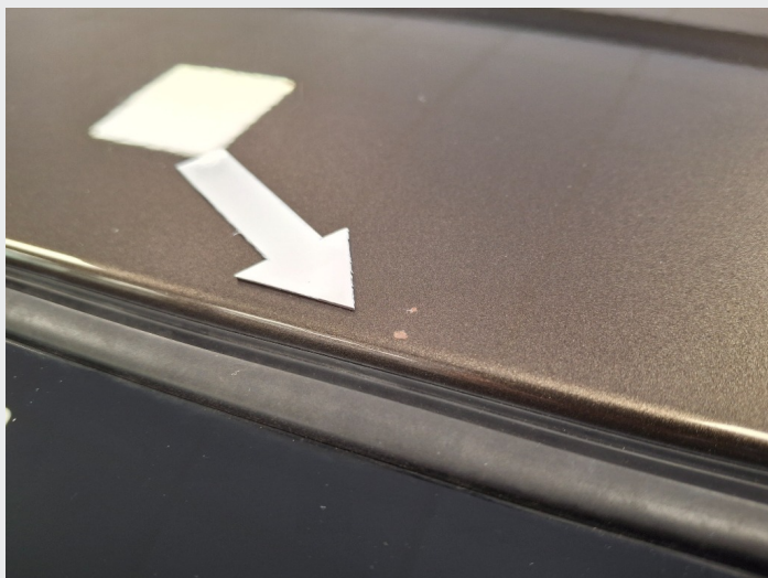
2.10 Steinsprut på tak
