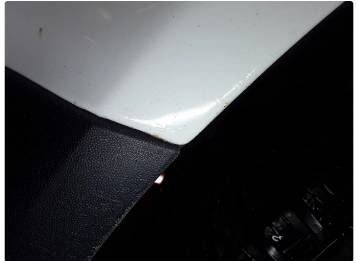
1.3 Noen steinsprut med korrosjon.
