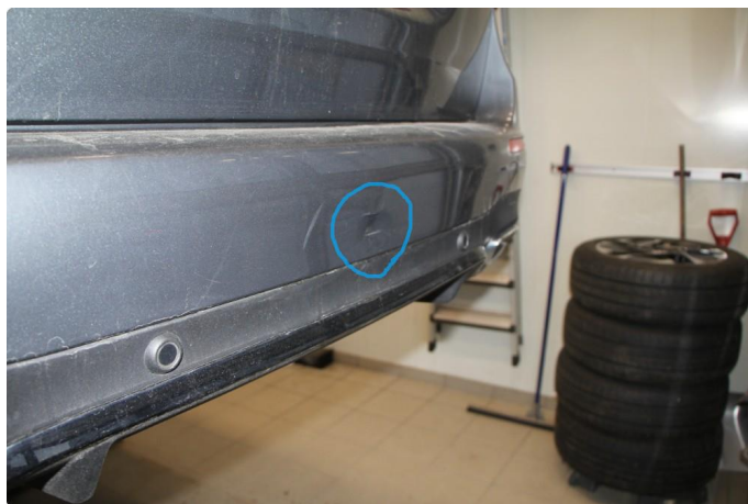
2.4 Sprekk/bulk i fanger.
