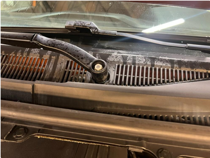
1.1 Mangler deksel pusserarm - Fikses før salg
