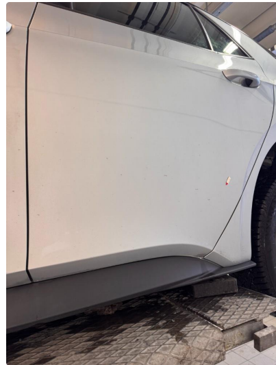
1.2 Noen små steinsprut med korrosjon.
