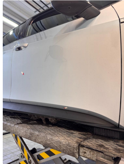
1.2 Noen små steinsprut med korrosjon.
