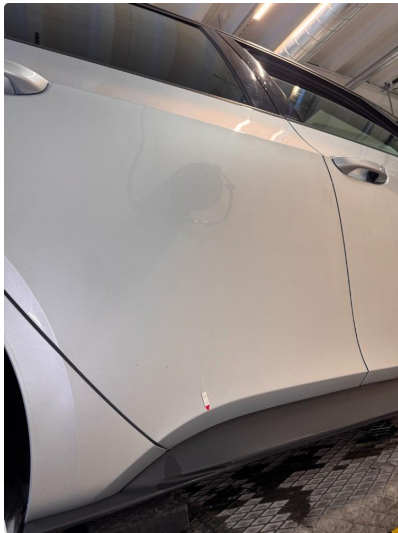
1.2 Noen små steinsprut med korrosjon.
