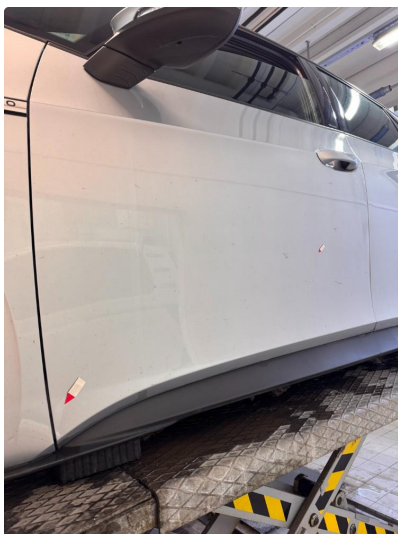
1.2 Noen små steinsprut med korrosjon.
