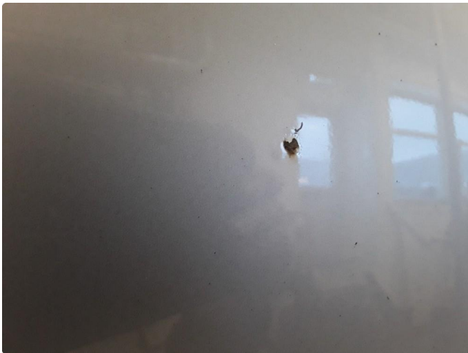
1.2 Liten steinsprut med korrosjon.
