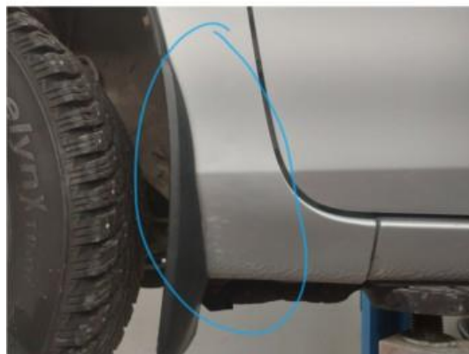
1.3 Liten bulk med lakkskade
