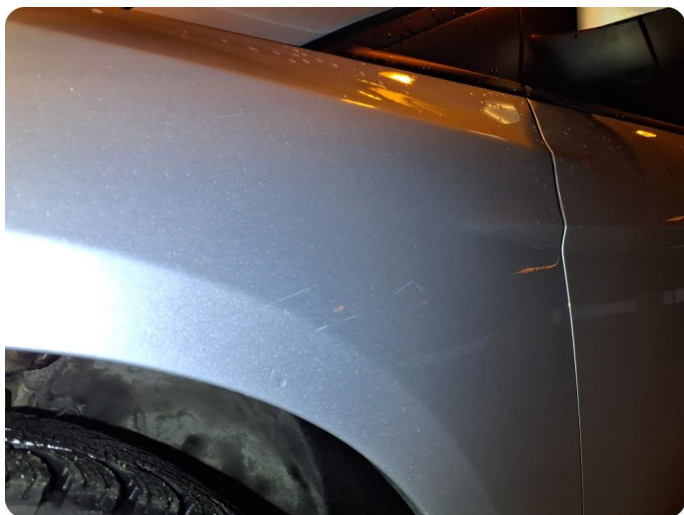
2.1 Generelt mye bruksslitasje Riper, steinsprut, hakk
