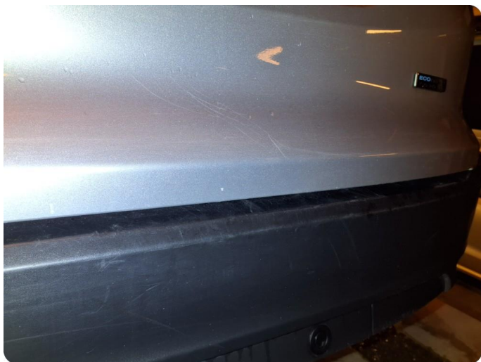
2.1 Generelt mye bruksslitasje Riper, steinsprut, hakk
