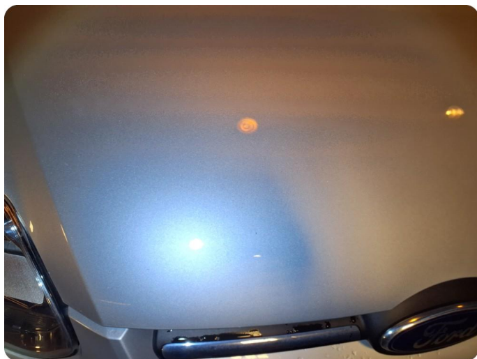
2.1 Generelt mye bruksslitasje Riper, steinsprut, hakk
