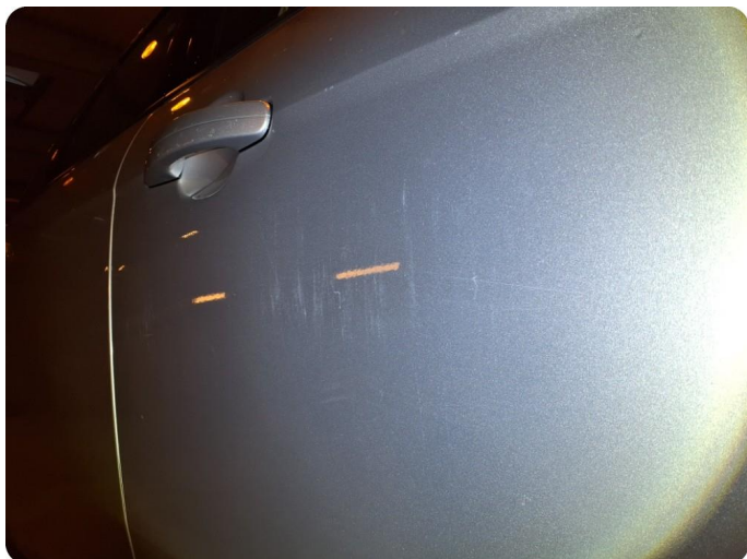
2.1 Generelt mye bruksslitasje Riper, steinsprut, hakk
