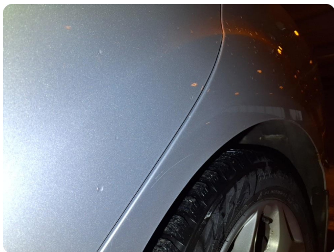
2.1 Generelt mye bruksslitasje Riper, steinsprut, hakk
