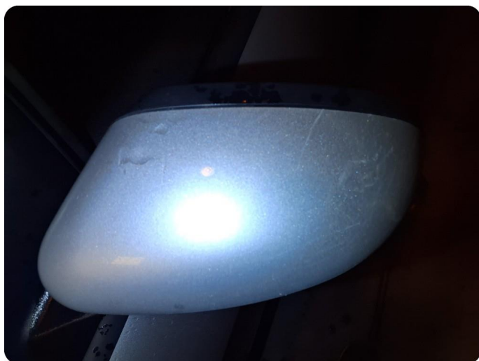
2.1 Generelt mye bruksslitasje Riper, steinsprut, hakk
