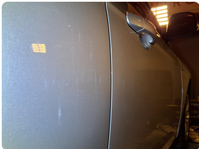
2.1 Generelt mye bruksslitasje Riper, steinsprut, hakk
