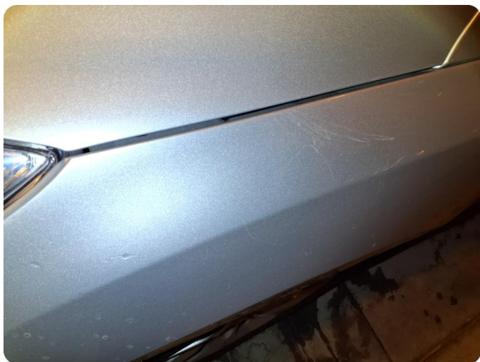
2.1 Generelt mye bruksslitasje Riper, steinsprut, hakk
