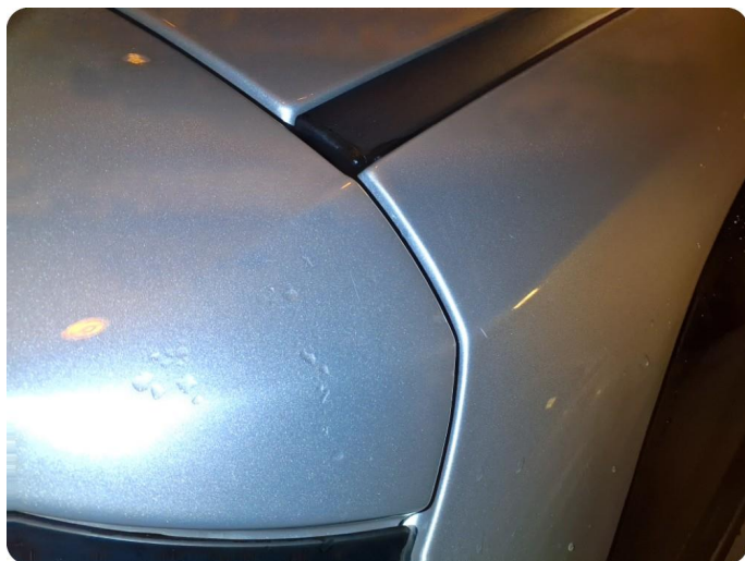
2.1 Generelt mye bruksslitasje Riper, steinsprut, hakk
