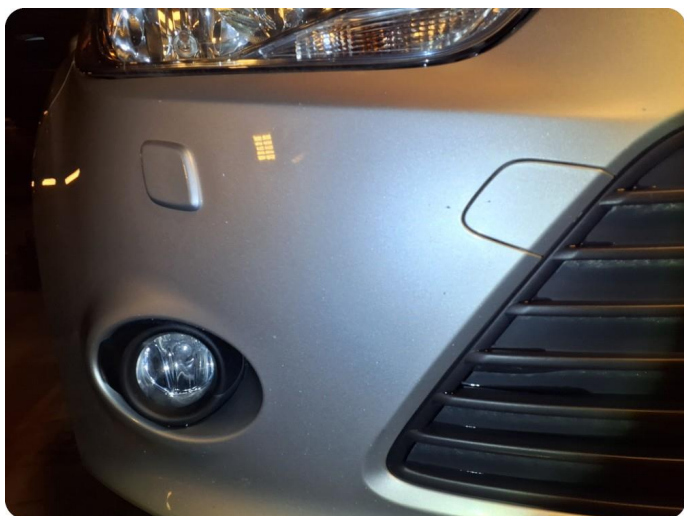
2.1 Generelt mye bruksslitasje Riper, steinsprut, hakk
