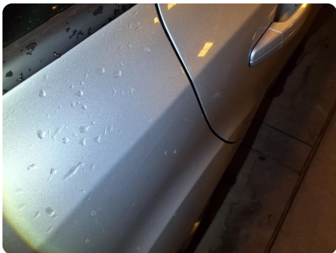
2.1 Generelt mye bruksslitasje Riper, steinsprut, hakk
