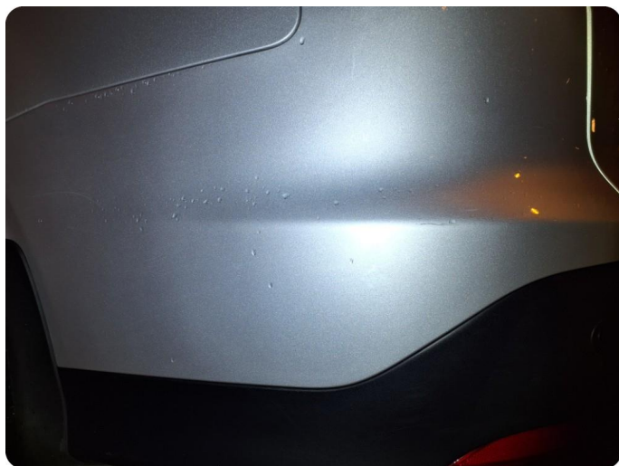
2.1 Generelt mye bruksslitasje Riper, steinsprut, hakk
