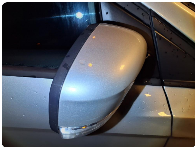
2.1 Generelt mye bruksslitasje Riper, steinsprut, hakk
