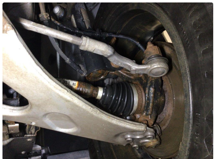
2.1 Overflaterust i forstilling, ingen tiltak kreves
