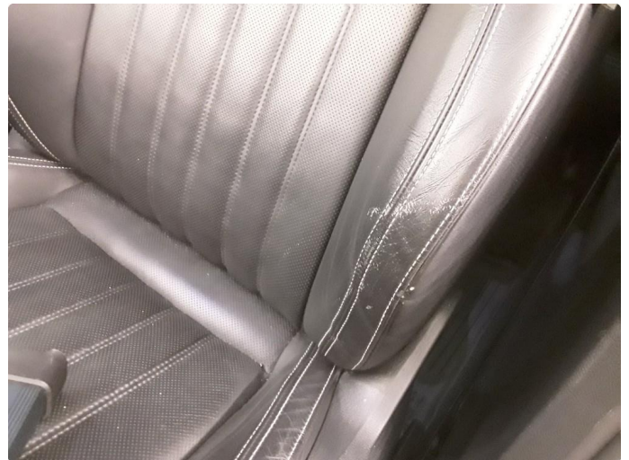
2.1 Litt slitasje fører sete, rygg venstre siden
