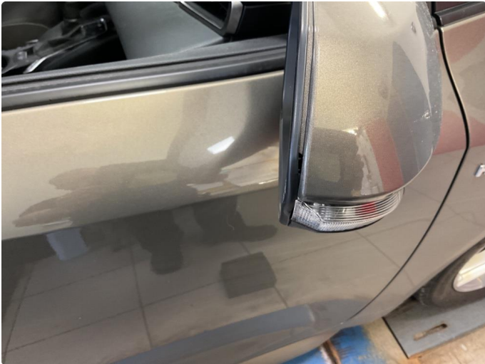
1.1 Speilhus liten skade i plast speil virker ok
