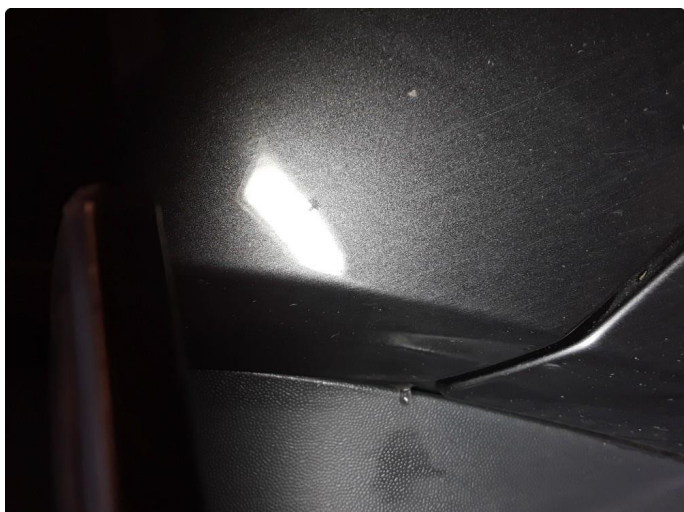
1.3 Liten steinsprut med korrosjon.
