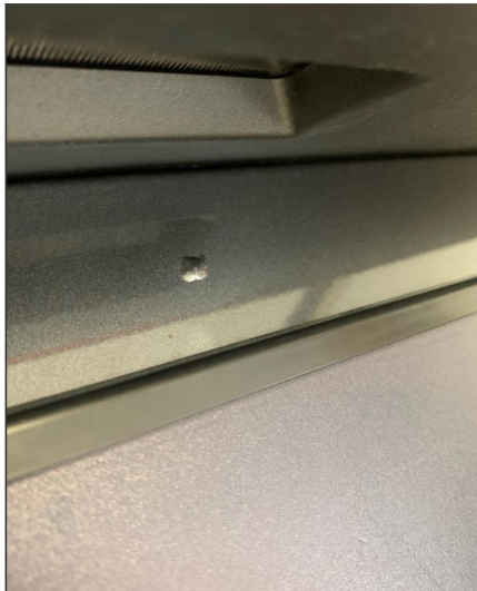
1.2 Liten steinsprut med korrosjon.
