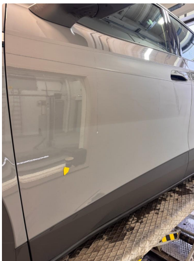
1.2 Noen små steinsprut med korrosjon.
