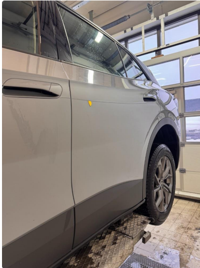
1.2 Noen små steinsprut med korrosjon.
