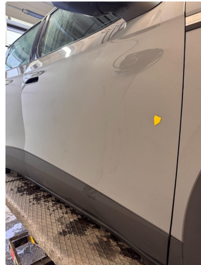
1.2 Noen små steinsprut med korrosjon.
