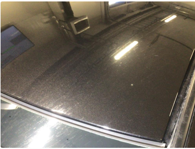
1.3 Noe steinsprut på tak
