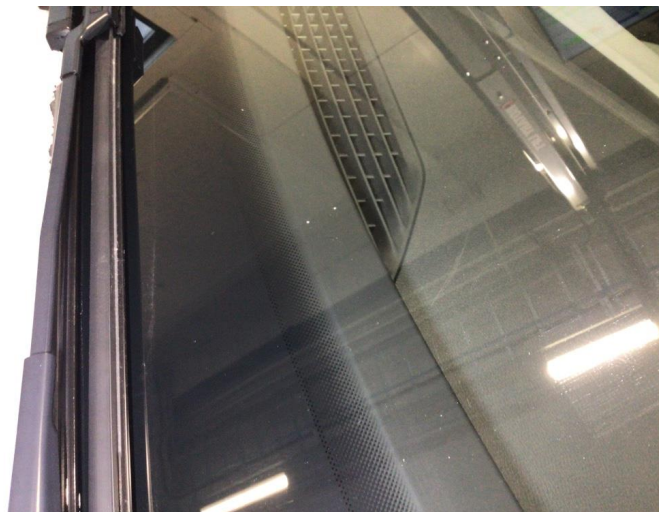
1.2 Noe steinsprut på frontvindu
