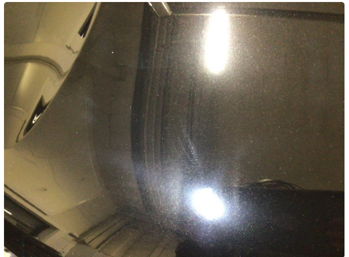
1.1 Noe steinsprut på panser
