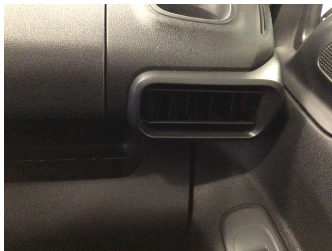
2.1 Mangler justeringsanordning til lufteventil høyre side
