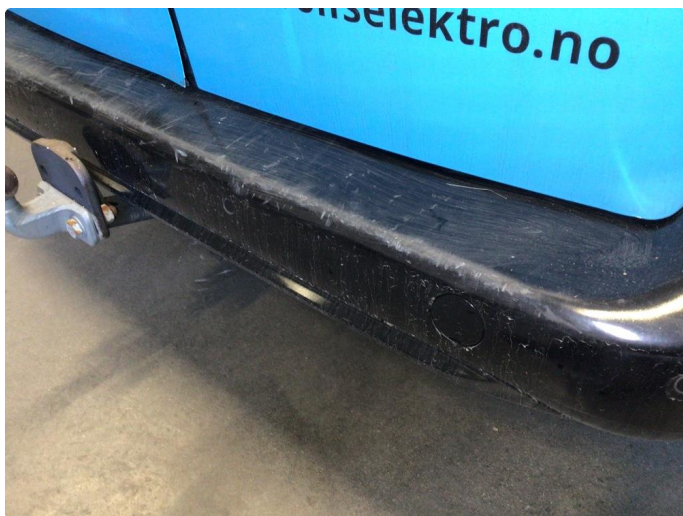
1.7 Bakfanger inneholder noen bruksmerker ved innlastingsone
