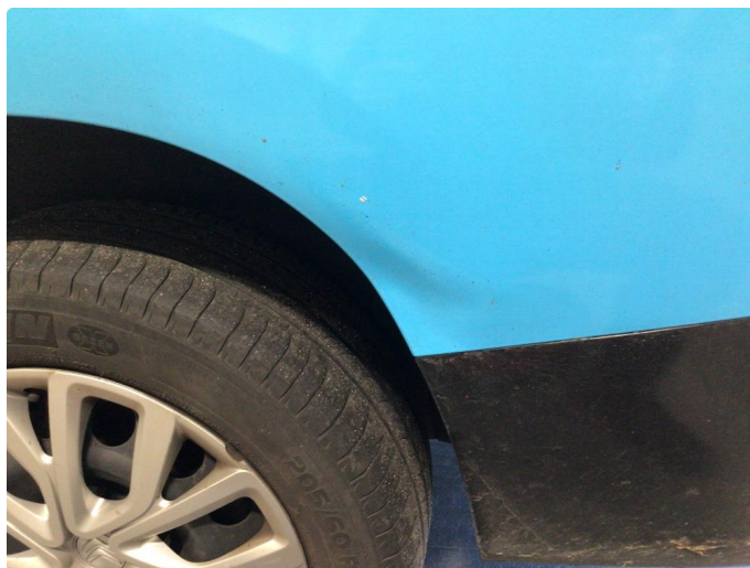
1.3 Bulk på venstre bakskjerm blir utbedret
