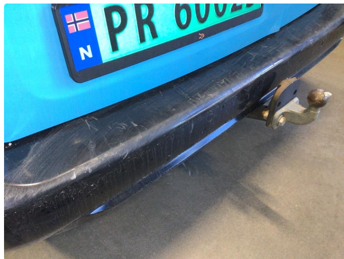
1.7 Bakfanger inneholder noen bruksmerker ved innlastingsone
