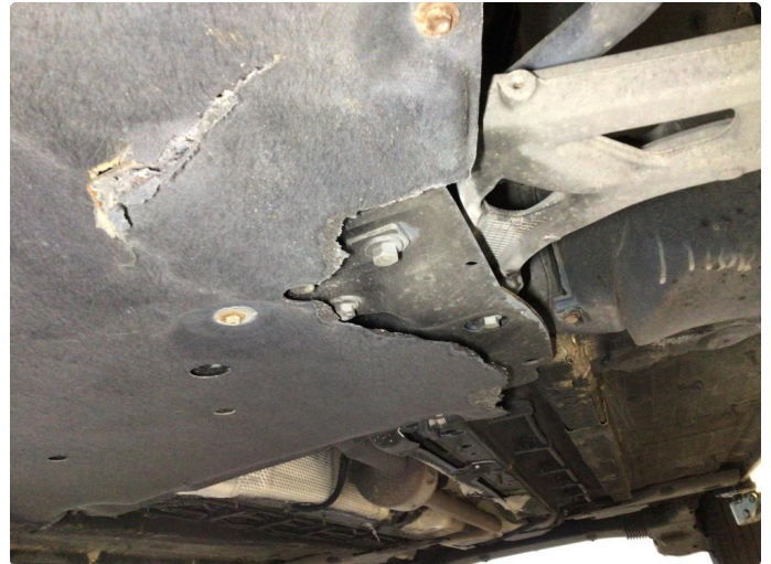
1.1 Beskyttelsesplate under motor er noe revnet
