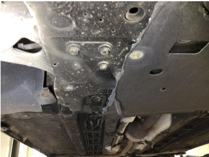
1.1 Beskyttelsesplate under motor er noe revnet
