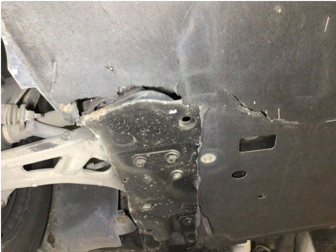
1.1 Beskyttelsesplate under motor er noe revnet
