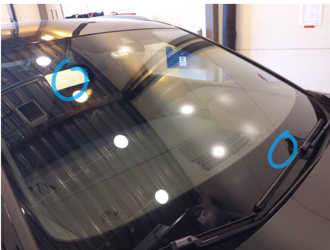
1.4 Steinsprut, denne er reparert
