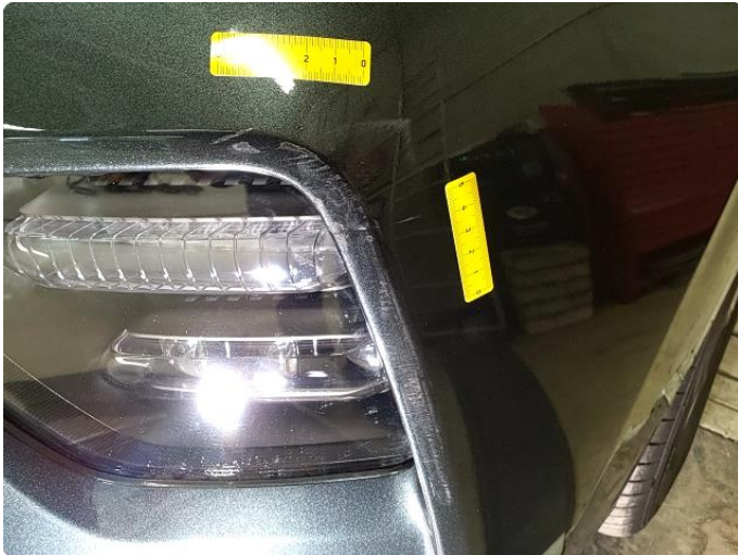
1.2 Ripe(r) ned til grunning
