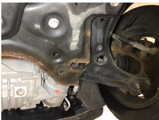
2.1 Overflaterust i forstilling/travers, ingen tiltak kreves
