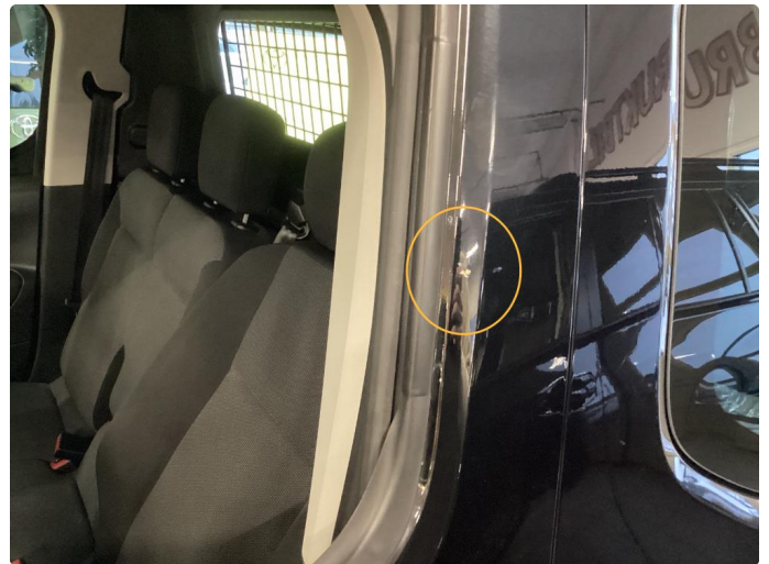
1.2 Hakk ved vindu førerdør
