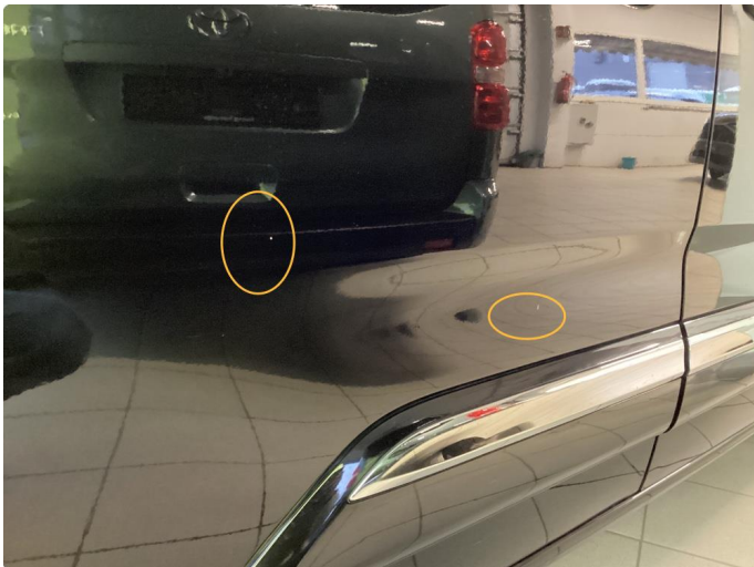
1.3 Steinsprut, hakk pass.dører
