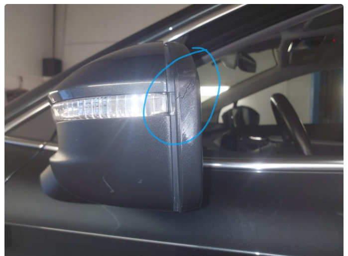
1.4 Sprekk i speilhuskanten
