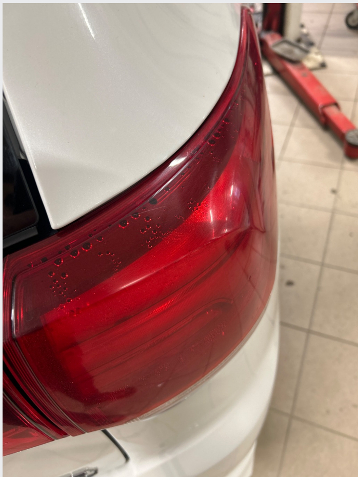
3.2 Fukt i ytre lykt h.b.
