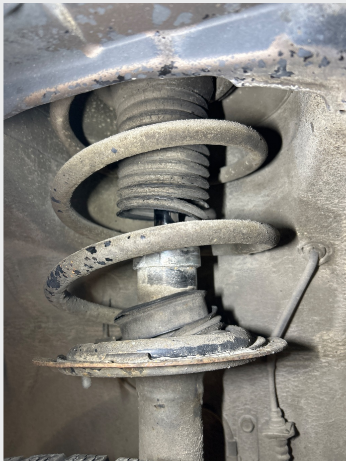
8.6 Mansjett på begge støtdempere foran er revnet
