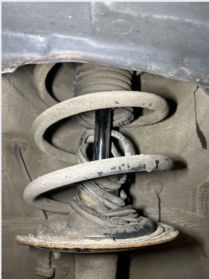
8.6 Mansjett på begge støtdempere foran er revnet
