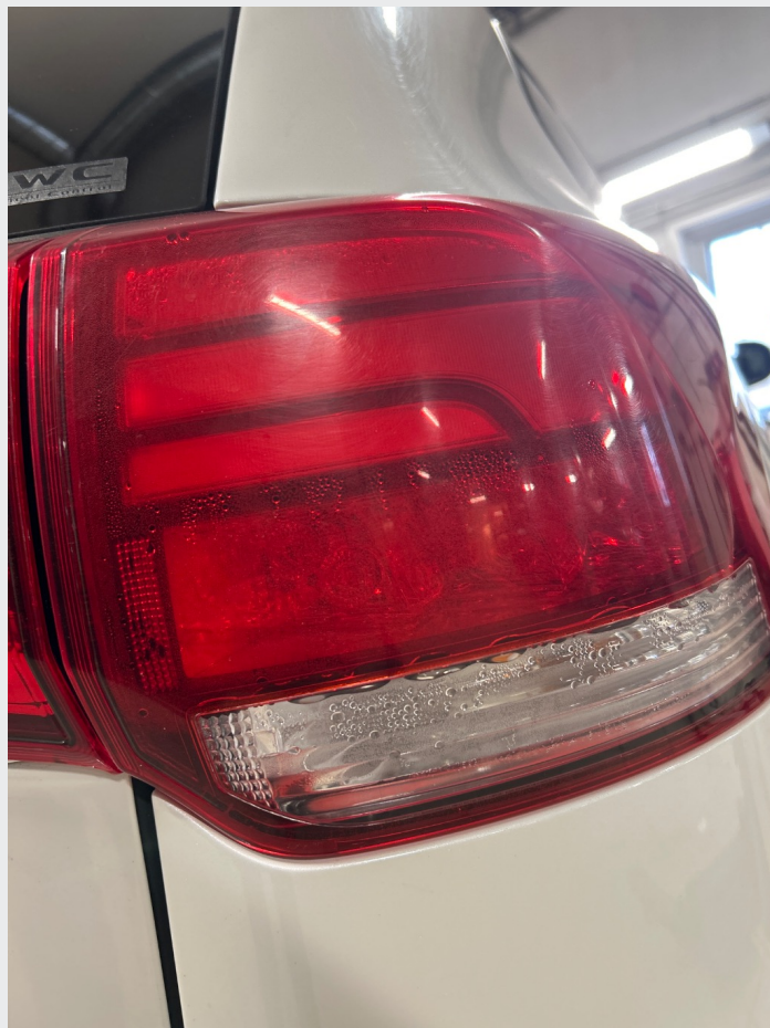
3.2 Fukt i ytre lykt h.b.
