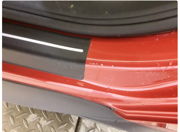
1.2 Små hakk terskel venstre bak, flekket
