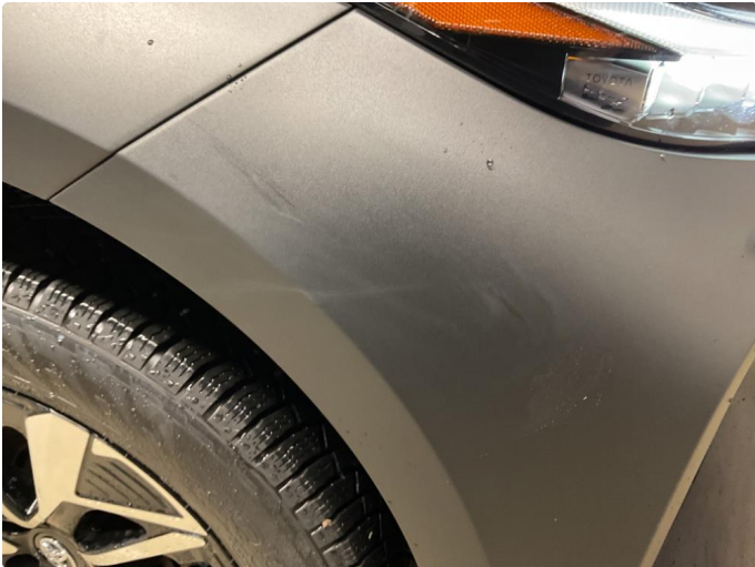
1.1 Høyre støtfanger foran svak ripe på plast. Merke på venstre side av støtfanger. Poleres. Pris kr. 3.000,- for polering av hel bil.
